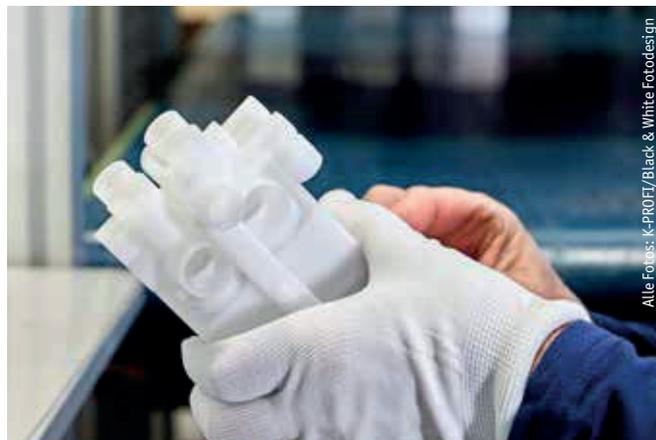
Die Kühlung mit flüssigem CO<sub>2</sub> eliminierte bei diesem komplexen Vierfach-Proportional-Ventilgehäuse Luncker und reduzierte die Zykluszeit signifikant.
