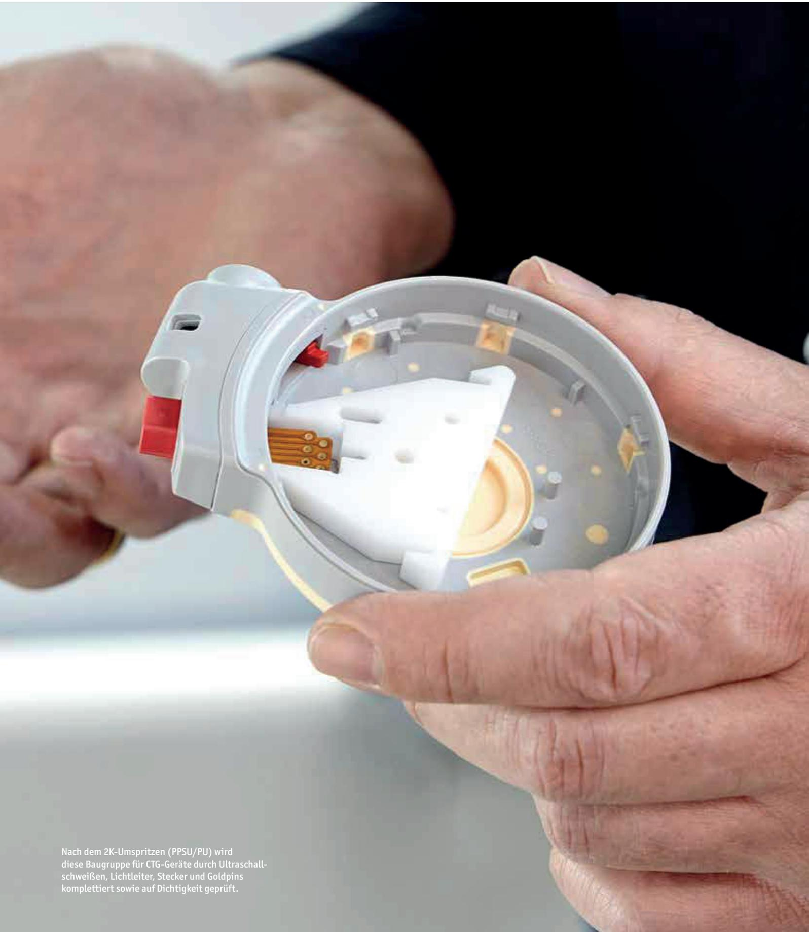
Nach dem 2K-Umspritzen (PPSU/PU) wird diese Baugruppe für CTG-Geräte durch Ultraschallschweißen, Lichtleiter, Stecker und Goldpins komplettiert sowie auf Dichtigkeit geprüft.
