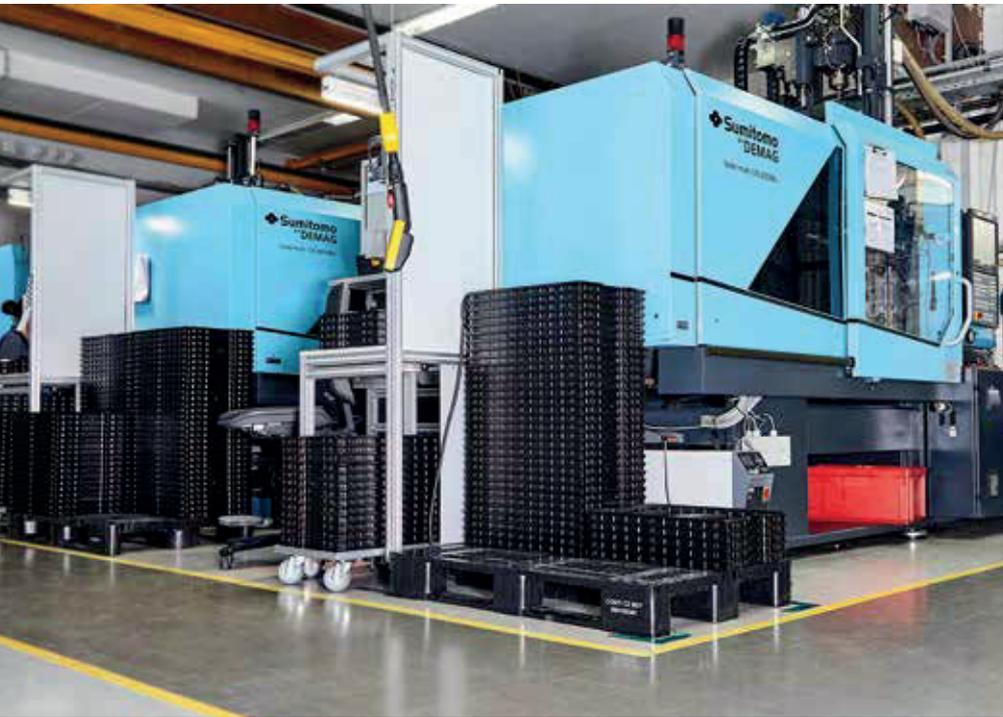
Rund um die Uhr produzieren vier automatisierte Fertigungsanlagen 2K-Lichtleiter für Gestiksteuerungen von Fahrzeug-Infotainmentsystemen.
